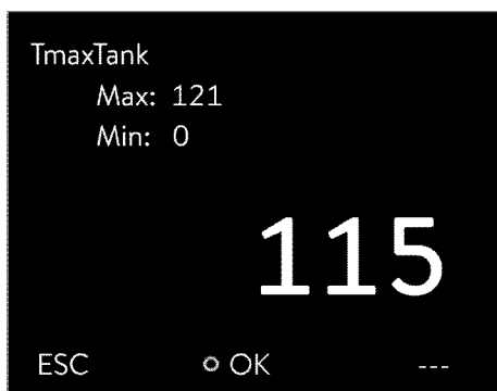
Fig. 42: Entering a new TmaxTank value
